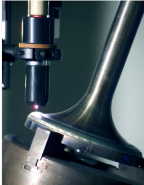
等离子堆焊作为焊接领域中的一个分支，等离子堆焊技术的应用范围非常普遍，几乎遍及所有的制造业，如矿山机械、工程机械、冶金机械、动力机械、农业机械、汽车、石油设备、化工设备、建筑施工以及工具模具及金属结构件的制造与维修中。通过等离子堆焊可以修复加强外形磨损的金属零部件及产品，或制造双金属合金零部件。采用等离子堆焊可以延长零部件的使用寿命，降低成本，改进产品设计，尤其对合理使用材料（特别是贵重金属）具有重要意义。在众多应用中，等离子堆焊主要是为了达到以下目的：恢复工件尺寸（等离子修复再制造）：由于恶劣的工况造成磨损致使零部件尺寸不足，无法正常使用，是让工矿企业经常头疼的问题。通常只是在工件局部产生磨损，而就这样随意丢弃这些磨损件，是不符合当前提倡环保和构建节约型社会的大潮流的。采用等离子堆焊耐磨合金方法修复上述工件，是一种非常有效的工艺方法。
