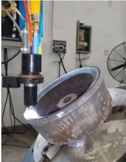
等离子堆焊技术在煤矿机械行业应用：液压支柱柱塞：液压支柱是矿井中使用量较大的装备，作为整机重要的部件—液压缸柱塞，受到环境腐蚀和运行中的擦伤，目前矿井中使用的液压支柱的柱塞以前是采用的镀铬处理，由于镀铬层很薄，防腐蚀和耐擦伤性能都很差，使用寿命短，一般只能维持2-3年。由于镀铬处理对环境的污染十分严重，已经被明令禁止。目前修复液压支柱采用激光熔敷工艺，该工艺虽然好，但设备昂贵，维护较为复杂，运行成本居高不下。采用等离子堆焊的方法在柱塞表面堆焊耐磨合金，具有生产效率高、运行成本低、工艺稳定、易于操控等一系列优点，是替代电镀的理想方法，而设备投资远低于激光熔敷机，优越性突出。工程机械量大面广，采用等离子堆焊技术能够极大提高使用寿命，还可实现零部件的再制造。吉林阀门等离子堆焊设备
